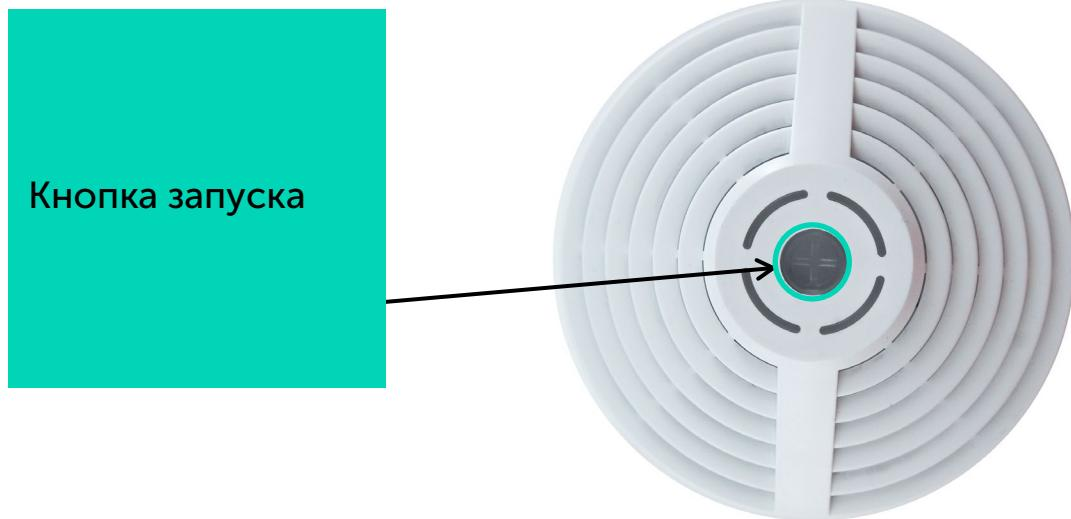
2. Способ ОТАА. После нажатия на кнопку запуска, устройство осуществит три попытки присоединения к сети в заданном при настройке частотном плане. При получении подтверждения активации в сети LoRaWAN, устройство подаст сигнал индикатором (свечение в течение 5 секунд) и перейдет в режим «Активный». Если все попытки окажутся неудачными, датчик продолжит накопление данных и будет осуществлять попытки присоединения к сети раз в 6 часов.
